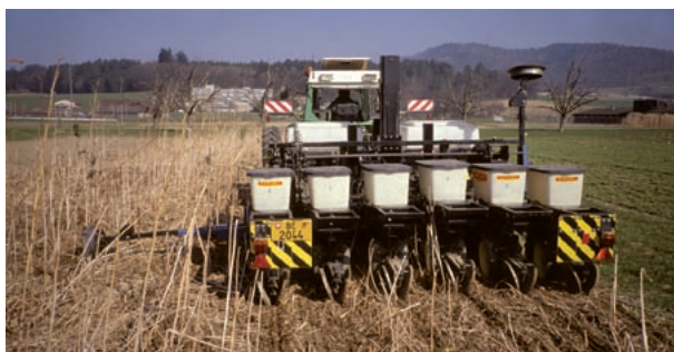
Direct seeder (no-till equipment) in operation (Source: Jana Epperlein, Gesellschaft für konservierende Bodenbearbeitung e.V., Germany)
